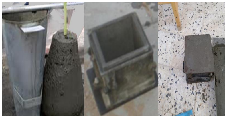
شكل (4) مخروط الهبوط القياسي والقوالب المكعبة.
