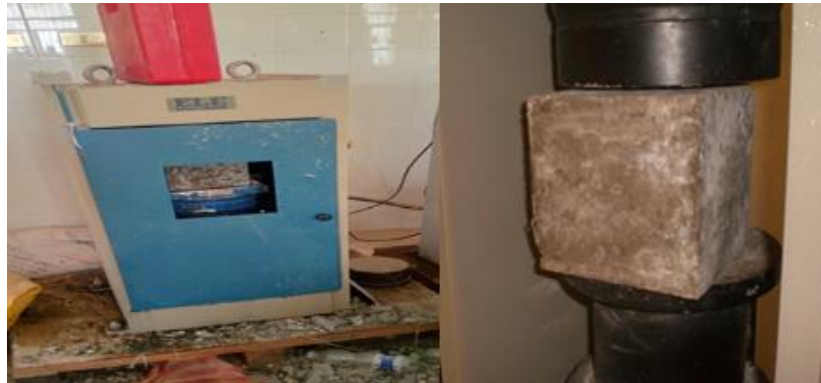
شكل (6) اختبار مقاومة الضغط
